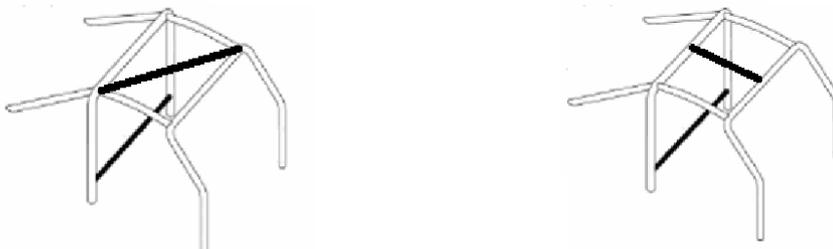
Die entstandene Öffnung muss im Bereich über dem Fahrer metallisch verschlossen und mindestens alle 100mm befestigt sein, die Wandstärke muss bei Stahlblech 1mm und bei Alublech 2mm betragen.
