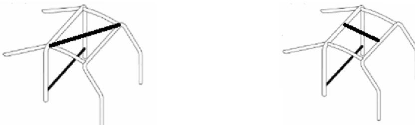
**Die entstandene Öffnung muss im Bereich über dem Fahrer metallisch verschlossen und mindestens aller 100mm befestigt sein, die Wandstärke muss bei Stahlblech 1mm und bei Alublech 2mm betragen.**
